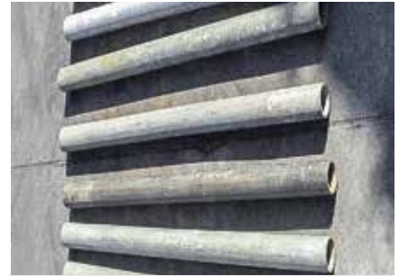
Tubo de andamio ■ Doblado ■ Sin abolladuras ni deformaciones en el perfil del tubo ■ Flexión permitida \leq L/200
