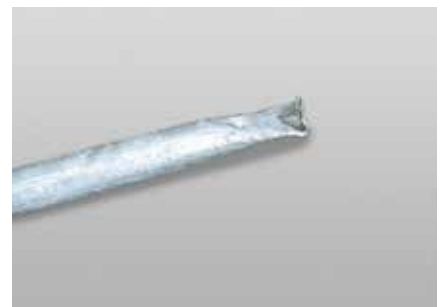
Barandilla UPG ■ Doblado ■ Grietas visibles ■ Desviación de ángulo admisible > 45°
