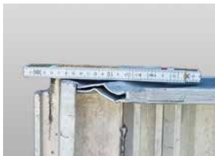
Escalera de andamio ■ Deformación/daño en un punto del perfil de bastidor sobre la barandilla para descanso
