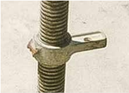
Husillos UJB/UJS/TR 38-70/50 ■ Tuerca mariposa defectuosa
