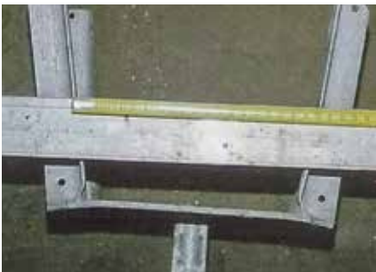
Cabezal 20/24 ■ Placa cabezal doblada > 5 mm
