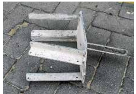
Cabezal ■ Doblado ■ Doblado y con grietas en el cordón de soldadura ■ Ángulo dañado
