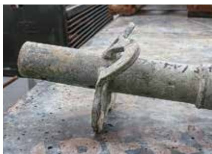
Montantes verticales UVR/UVB ■ Roseta doblada ■ Flexión permitida \leq 20 mm
