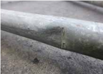
Torsión en el bastidor MRK o PRK
