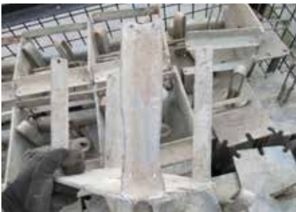
Los ángulos del cabezal están doblados
