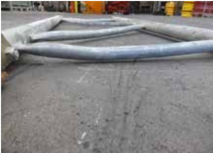
Bastidor MRK o PRK ligeramente doblado • Sin grietas en la costura de soldadura
