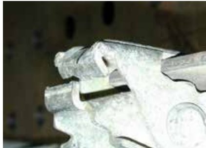
La conexión MRK está doblada • Sujeción imposible
