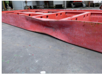
Abolladura en el perfil longitudinal
