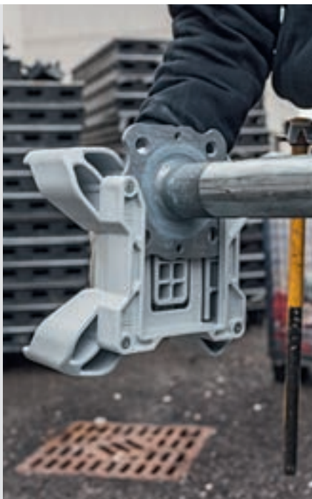
El cabezal de apoyo DUO puede utilizarse para placas base de hasta 120 mm de canto y 5 mm a 8 mm de espesor.
