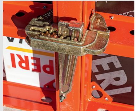
Para posicionar los paneles LIWA se usa el cerrojo LRS. Se utiliza tanto para encuentros normales de paneles, para uniones en altura y para compensaciones longitudinales hasta 5 cm. Al golpear la cuña con el martillo, los paneles LIWA se enrasan, se alinean y se unen de modo estanco. Los paneles también pueden alinearse con la pieza auxiliar de carga y una madera escuadrada, o bien con una abrazadera para madera escuadrada y viga de encofrado.
