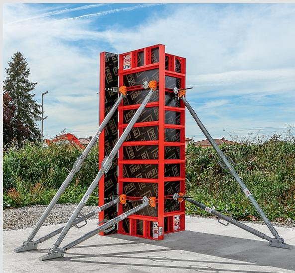
Con los paneles multifunción LWM 75 pueden encofrarse secciones de pilares desde 15 cm hasta 55 cm, modulados cada 5 cm. Los paneles se unen con conectores de esquina.
