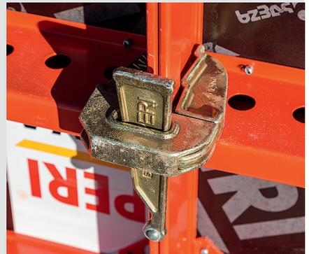
Para compensaciones de muros hasta 5 cm se usa el cerrojo de compensación LIWA. Para compensar se usa o bien una madera escuadrada o la regleta de compensación LW de 5 cm de ancho. El cerrojo, además, se puede usar para encuentros normales de paneles.
